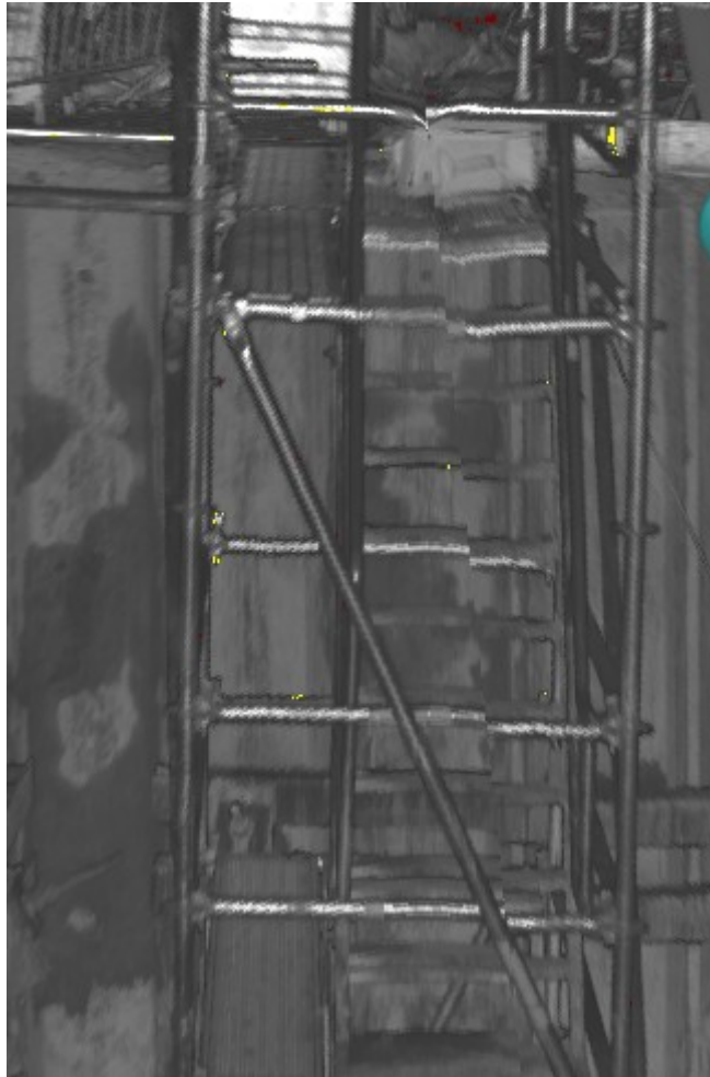
27. ábra Mérés közben megmozdított szkennerből exportált pontfelhő, jól látható a 'törés' a létrában.
